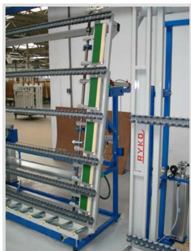
VK3532 mit 0°/10° Schwenkeinheit VK3532 incl. 0°/10° tilting unit
