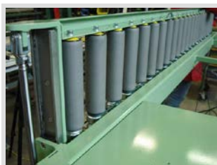
Pneumatisch versenkbare Rollenbahn Pneumatic retractable roller track
