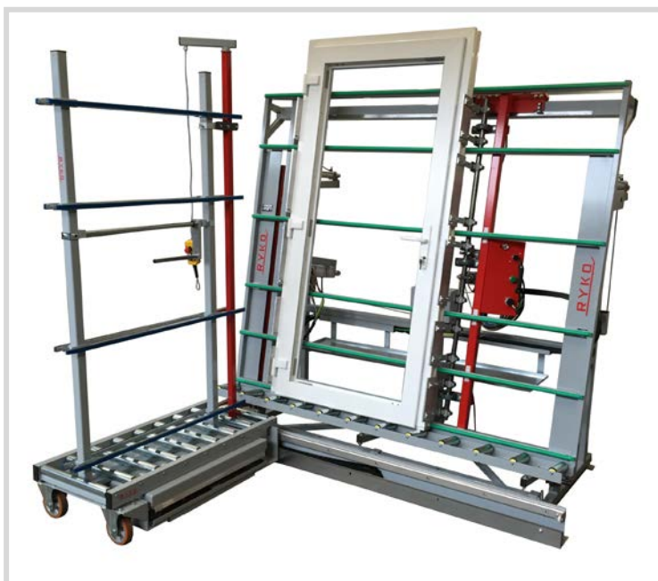
VK3532 mit 0°/10° Schwenkeinheit, Einhängewagen mit Hub für Typ VK VK3532 incl. 0°/10° tilting unit, Slip-In wagon incl. lift for type VK
