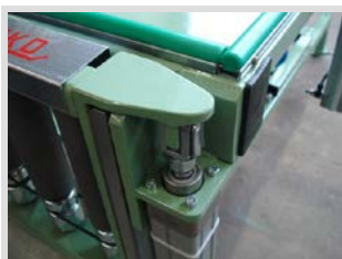
Pneumatisch versenkbare Rollenbahn Pneumatic retractable roller track
