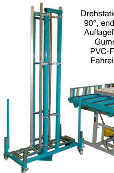
Drehstation mit Rastpunkten alle 90°, endlos drehba. Rollenbahn Auflagefläche, Anlagefläche mit Gummirollen, Gleitprofil oder PVC-Filzleiste je nach Bedarf, Fahreinrichtung und Feststellbremse manuell.
