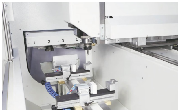
Pneumatischer Schraubstock mit manueller Positionierung
